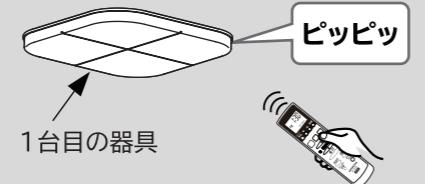
4 リモコンのチャンネル切替ボタンを押して、表示画面のチャンネル表示を“チャンネル2”にしてください。
