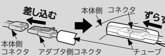
8 チューブの端(針で止めてある部分)を、配線押えの下に押し込んでください。
