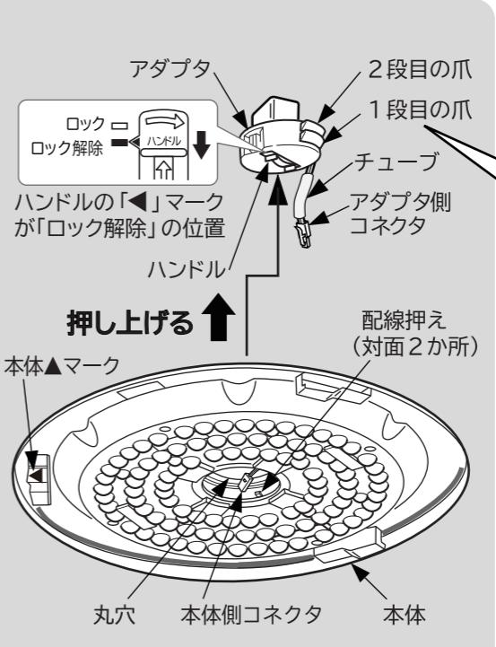
5 アダプタ側コネクタを本体の丸穴に通し、丸穴をアダプタに合わせて、アダプタ両側の爪に掛かるまで押し上げてください。
